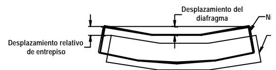
Figura 3.14 Deformaciones en un diafragma de piso rígido deformaciones llevaron a distorsiones de entrepiso bastante mayores que las consideradas en el diseño original.
